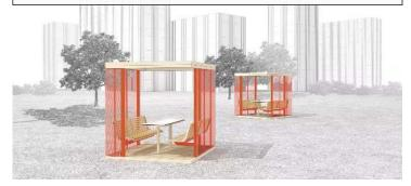
Pavillon CUBY SNACK zum Aufdübeln bei +/- 0 mm, Dachbreite x Dachtiefe 2200 mm x 2200 mm, Dacheindeckung aus Solarpanel, Wandelemente aus Holzlamellen bzw. Stahlseilen als Rankhilfe inkl. Pflanzbehälter (auftragsbezogene Anpassung), Stahlkonstruktion in RAL 7016 anthrazitgrau, Sitzbänke und Tisch mit Jatobaholzbelattung gegen Mehrpreis
