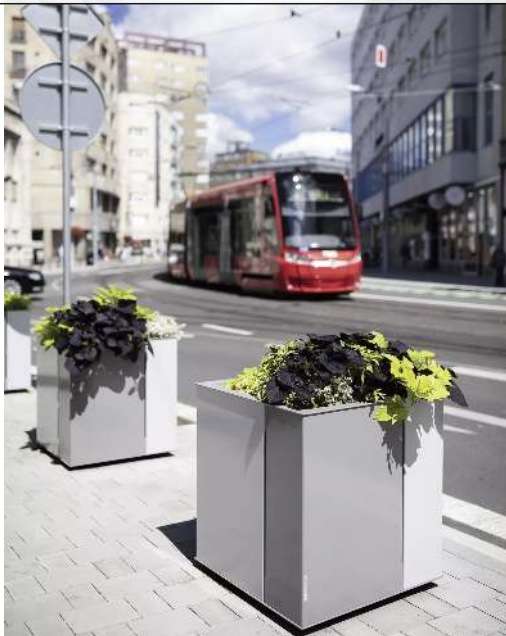
Pflanzbehälter MALAGENO, 700 x 700 mm, in RAL 7035 lichtgrau und RAL 9007 graualuminiun (zweifarbzig auf Anfrage)
