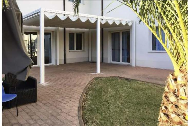
Pergola PESARO als Sonnenschutz, Dachbreite x Dachtiefe 16000 x 5000 mm, Dacheindeckung mit lichtundurchlässiger PVC-Plane, Aluminium-Konstruktion in weiß pulverbeschichtet
