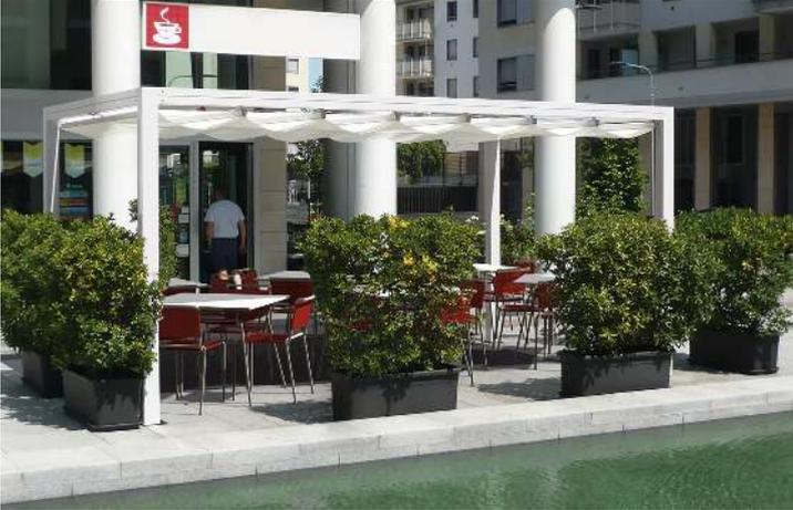
Pergola PESARO als Lounge-Ecke, Dachbreite x Dachtiefe 3000 x 4000 mm, Dacheindeckung mit lichtundurchlässiger PVC-Plane, Aluminium-Konstruktion in taubengrau pulverbeschichtet
