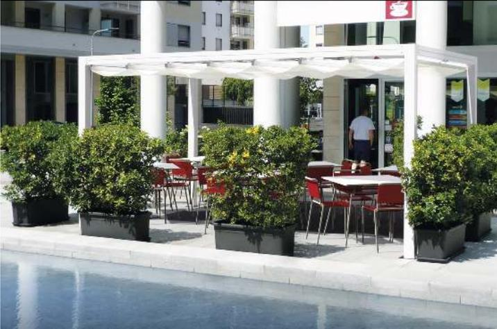
Pergola PESARO als Sonnenschutz, Dachbreite x Dachtiefe 3000 mm x 6000 mm, Dacheindeckung mit lichtundurchlässiger PVC-Plane, Aluminiumkonstruktion in weiß pulverbeschichtet
