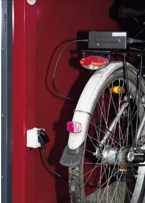
Detail: Elektroleiste mit 230V-Steckdose und LED-Licht
