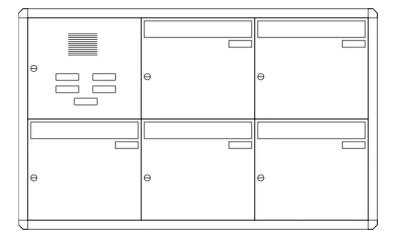
Aufputzanlage NIZZA, mit 5 Briefkästen, 1 Installationskasten (325 x 390 x 100 mm) mit 5 Klingeltasten und 1 Sprechgitter, in RAL 9016 verkehrsweiß
