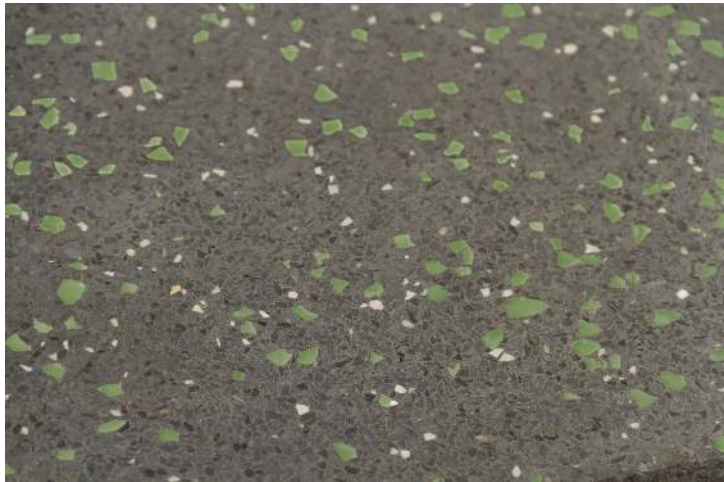
Detail: Beton schwarz mit grün lumineszierenden Partikeln
