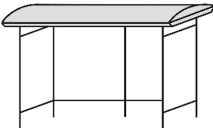
Oberfläche Stahlteile : feuerverzinkt und pulverbeschichtet
