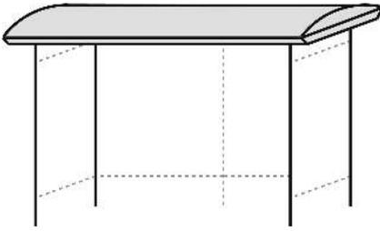
Oberfläche Stahlteile : feuerverzinkt und pulverbeschichtet
