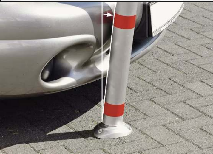
Die Bodenplatte ist mit einem Federmechanismus versehen, der den Sperrpfosten nach einem eventuellen Anfahren (bis etwa 30° Neigung) selbsttätig wieder aufrichtet.
