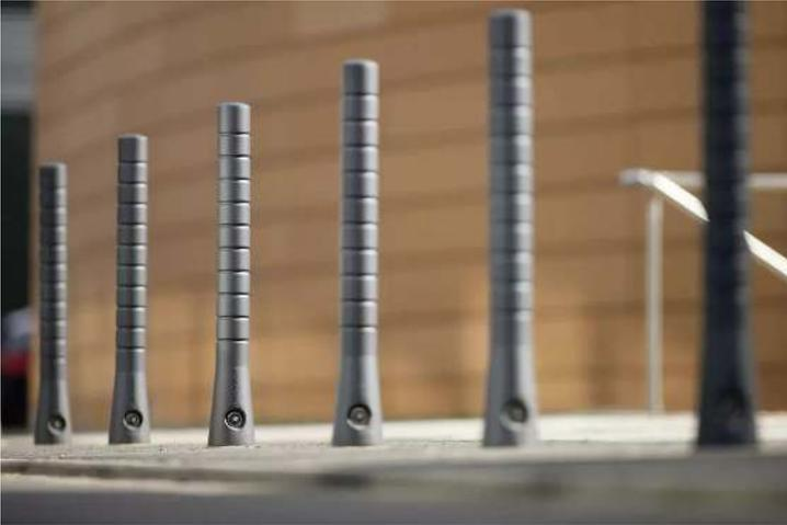
Poller TARANIS (3p-Technologie) mit zehn Rillen, konisch, Verriegelung mittels Sechskantschraube, in DB 703 eisenglimmer
