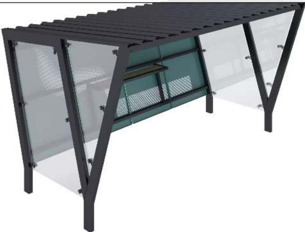
Raucherunterstand TAURI, Dachbreite x Dachtiefe 3940 mm x 2500 mm, einseitig, Dacheindeckung Trapezblech, Rückwand perforiertes Stahlblech, Seitenwand ESG, Klarglas bzw. perforiertem Stahlblech, Stahlkonstruktion in RAL 7016 anthrazitgrau
