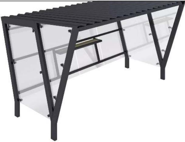
Raucherunterstand TAURI, Dachbreite x Dachtiefe 3940 mm x 2500 mm, einseitig, Dacheindeckung Trapezblech, Rückwand ESG, Klarglas, Seitenwand ESG, Klarglas bzw. perforiertem Stahlblech, Stahlkonstruktion in RAL 7016 anthrazitgrau
