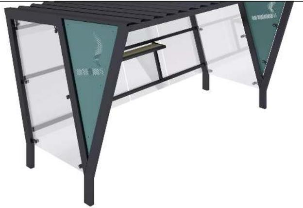
Raucherunterstand TAURI, Dachbreite x Dachtiefe 3940 mm x 2500 mm, einseitig, Dacheindeckung Trapezblech, Rückwand perforiertes Stahlblech, Seitenwand ESG, Klarglas, Stahlkonstruktion in RAL 7016 anthrazitgrau
