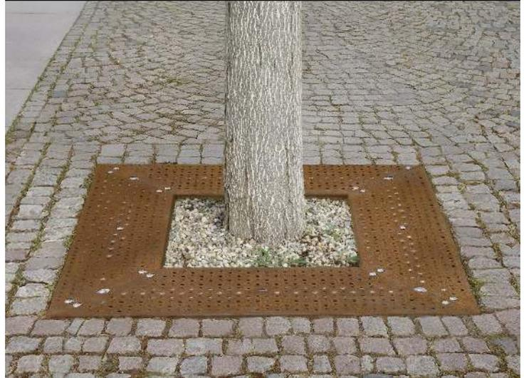
Baumschutzrost TABER, Breite x Tiefe 2000 x 2000 mm, mit Fahrradanhänger aus verzinktem Stahl, Unterkonstruktion verzinkt, Blechprofil-Segmente mit Prägung City in RAL 7016 anthrazitgrau
