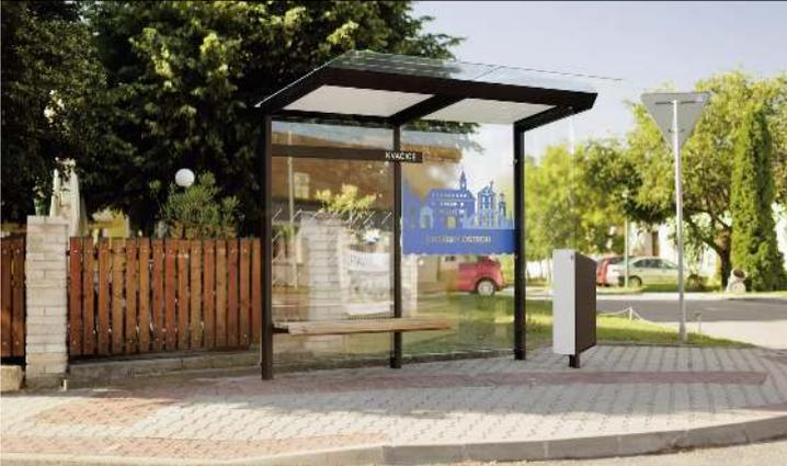
Wartehalle TRAXO, Dachbreite x Dachtiefe 2800 mm x 1740 mm, Rück- / Seitenwände ESG, Klarglas, mit bauseitiger Beklebung sowie Abfallsammler (auftragsbezogen), Sitzbank Thermoholz Esche, Stahlkonstruktion in RAL 9005 tiefschwarz
