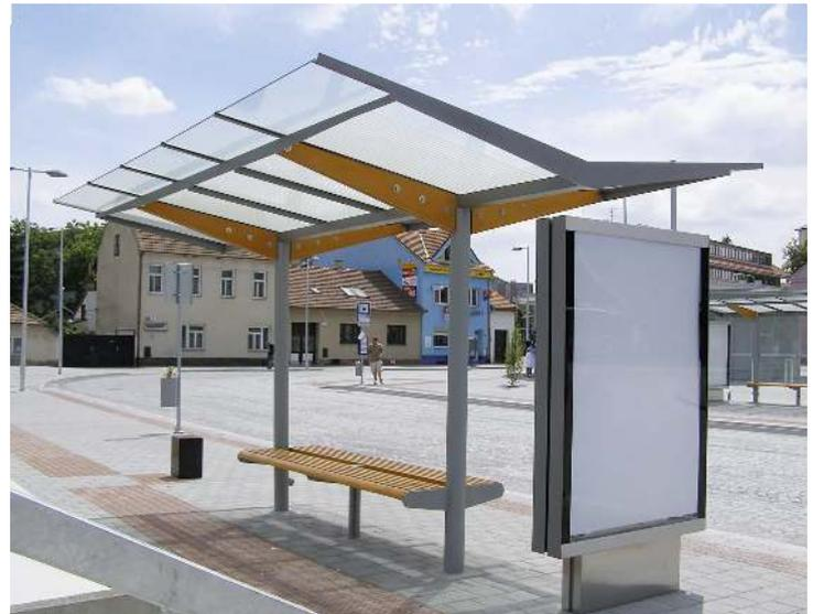
Wartehalle REGIO Dachbreite x Dachtiefe 4850 mm x 1850 mm, Stahlkonstruktion spritzverzinkt und pulverbeschichtet, inkl. Rück- und Seitenwände ESG, Klarglas, mit Siebdruckdekor und Sitzbank, Dacheindeckung VSG, Klarglas mit Siebdruckstreifen
