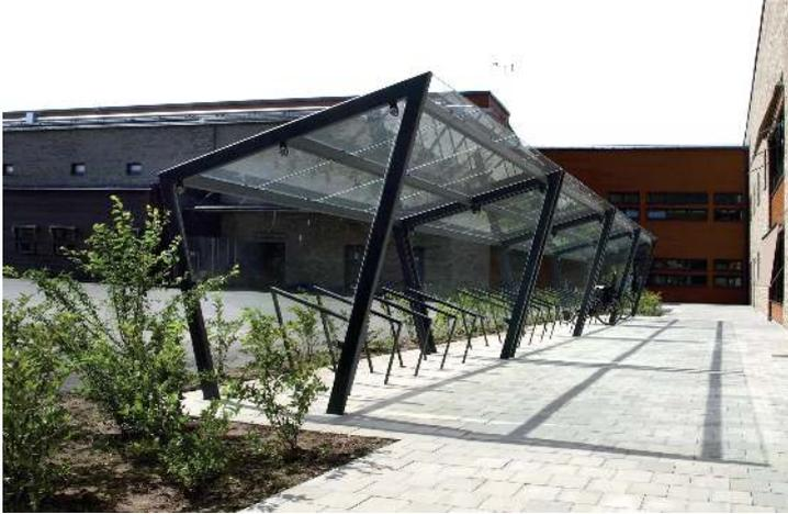
Fahrradüberdachung EDGE, einseitig, Dachbreite x Dachtiefe 3900 mm x 2500 mm, Dacheindeckung VSG, Klarglas, auftragsbezogenes Scheibendekor in der Seitenscheibe, mit Anlehnbügel EDGETYRE, Stahlkonstruktion in RAL 9007 graualuminium
