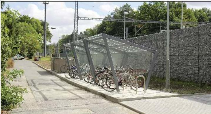
Fahrradüberdachung EDGE, einseitig, Dachbreite x Dachtiefe 7700 mm x 2500 mm bzw. 3900 mm x 2500 mm, Dacheindeckung VSG, Klarglas, mit Anlehnbügel EDGETYRE, Stahlkonstruktion in RAL 7016 anthrazitgrau
