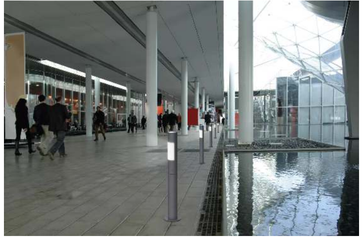
Pollerleuchte SAGUNT mit einseitigem Lichtaustritt, Höhe 900 mm
