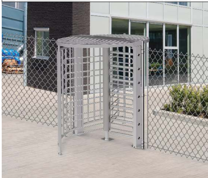
Drehkreuz LARDOS, zum Aufdübeln, ohne Bodenrahmen, mit Übersteigenschutz, feuerverzinkt
