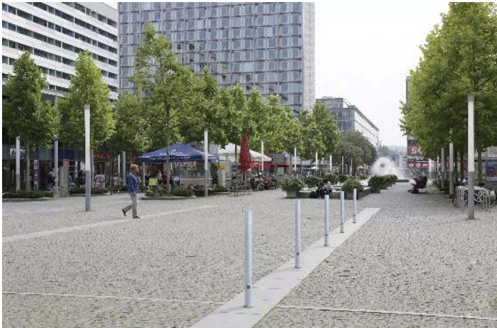
Poller MOSTOLES, feuerverzinkt, herausnehmbar aus Boden­hülse, mit Dreikantschloss
