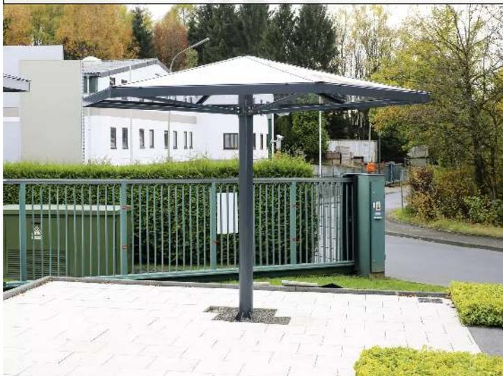
Raucherunterstand FUMAT, 4-eckig, Dachbreite x Dachtiefe 3027 mm x 3027 mm, Stehtisch inkl. Edelstahlascher gegen Mehrpreis, Stahlkonstruktion in RAL 7016 anthrazitgrau, im Hintergrund mit auftragsbezogener Anpassung als Fahrradüberdachung mit Hängeparker
