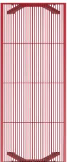
Oberfläche Unterkonstruktion : feuerverzinkt und pulverbeschichtet
