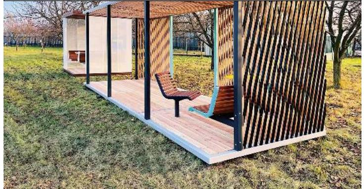
Pavillon CUBY MEET zum Aufdübeln bei +/- 0 mm, Dachbreite x Dachtiefe 2200 mm x 2200 mm, Dach und Wandelemente aus Holzlamellen, Stahlkonstruktion in RAL 7016 anthrazitgrau, Sitzbänke und Drehsitz mit Robinienholzbelattung sowie Tisch in RAL 7016 anthrazitgrau gegen Mehrpreis
