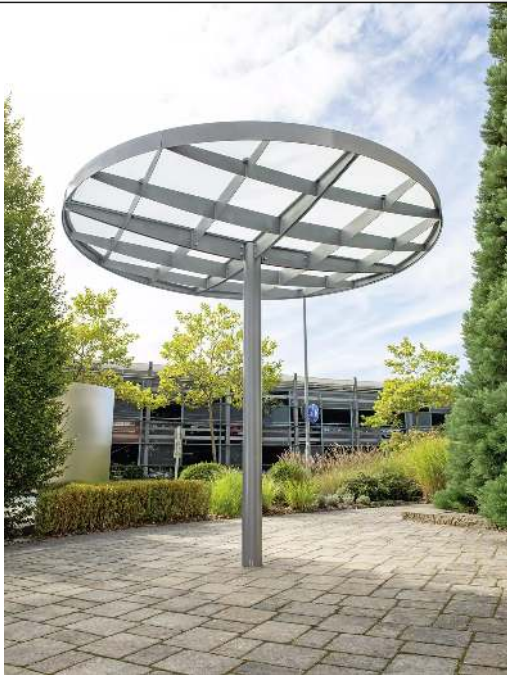
Meeting-Point PIN, Ø 3500 mm, Dacheindeckung VSG, Klarglas, Stahlkonstruktion in RAL 9007 grau aluminium
